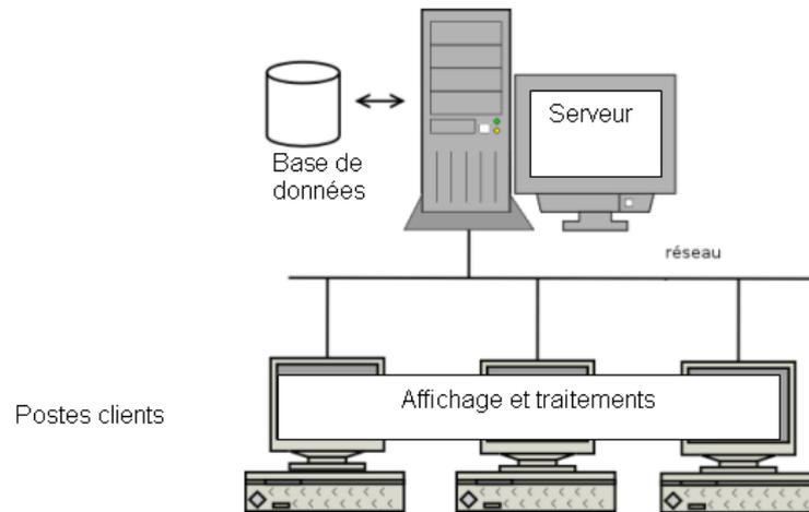
Ce type d'application permet d'utiliser toute la puissance des ordinateurs présents sur le réseau et permet de fournir à l'utilisateur une interface riche, tout en garantissant la cohérence des données qui restent gérées de façon centralisée.
